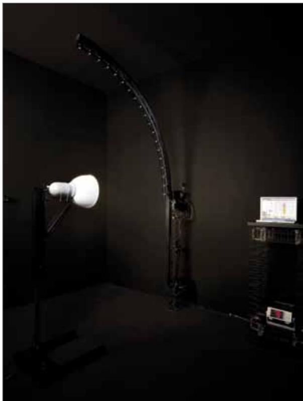
Per ottenere fedeli mappature tridimensionali di come la luce si distribuirà nello spazio intorno alla sorgente luminosa, verificandone così l'emissione e la conformità ai rigorosi standard progettuali, Aqlus è fra le poche aziende di illuminotecnica ad essersi dotata di un fotogoniometro di ultima generazione T4, Photoglobe II.
